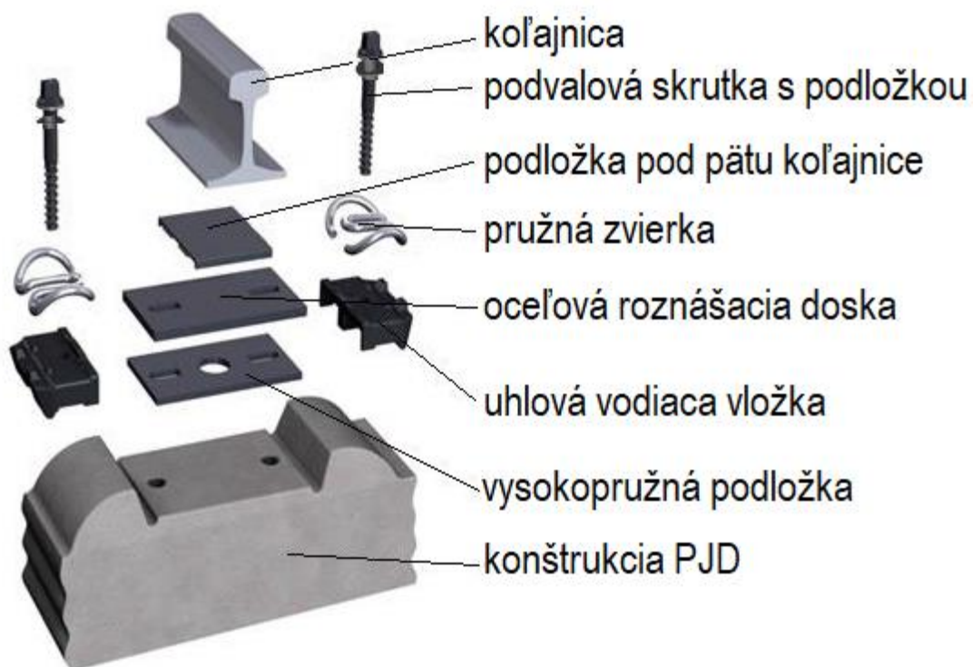
Obr. 5. Systém upevnenia do PJD 300-1/300-1U
